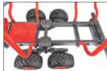
Assale idraulico spostabile per cambiamento del baricentro
