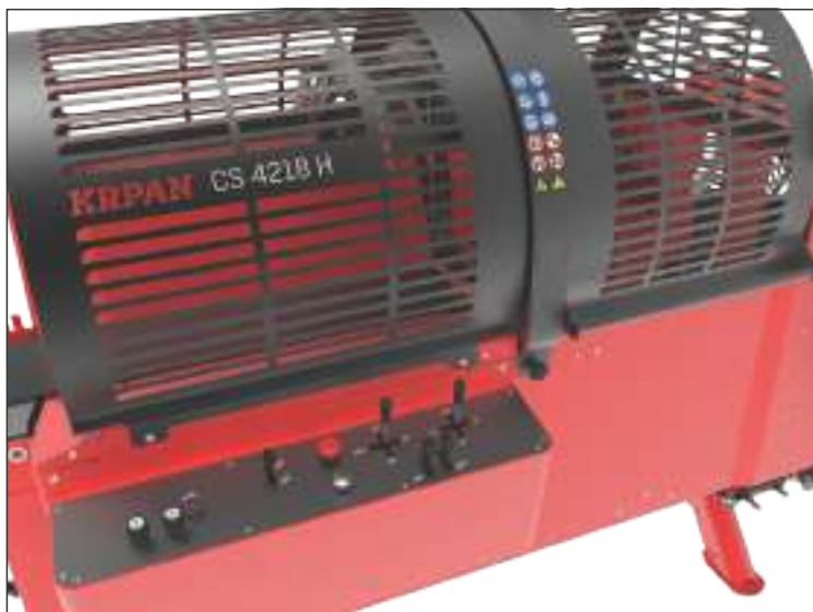
KR PAN CS 4218 H è comandato con comandi meccanici-idraulici
